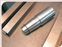
6. Podobnie jak z uszczelniaczem postępujemy z pierścieniem Segera – umieszczamy go na narzędziu montażowym Z-09620, przesuwamy na tuleję transportową i zsuwamy do rowka.
