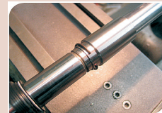
7. Następnie wciskamy pierścień w rowek bez ryzyka zdeformowania go czy też zarysowania listwy.
