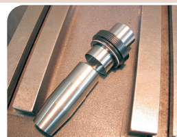
5. Zakładamy uszczelniacz na część stożkową narzędzia montażowego z serii Z-09319, następnie przesuwamy na tuleję transportową, a następnie na listwę.
