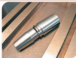
6. Podobnie jak z uszczelniaczem postępujemy z pierścieniem Segera – umieszczamy go na narzędziu montażowym Z-09620, przesuwamy na tuleję transportową i zsuwamy do rowka.
