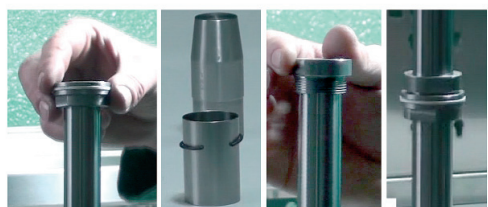
9. Tłoki firmy EMMETEC z serii K-Sxxxx pozwalają uprościć całą operację. Złożone z dwóch skręcających elementów eliminują konieczność zagniatania tłoka.
