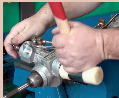
8. Ostrożnie wyciągamy rozdzielacz, bo to bardzo delikatny element.
