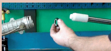
24. Umieszczamy wewnętrzny uszczelniacz na dobijaku Z-09700, aby wcisnąć go do środka obudowy przekładni.
