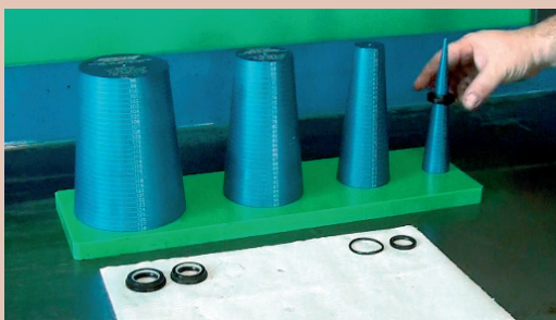
17. Mierzmy uszczelniacz, teflon i o-ringi stożkami Z-11000, bo jest to szybsze, łatwiejsze i precyzyjniejsze.
