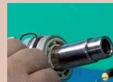
27. Wprowadzamy zgiętą stronę pierścienia SEGER w jego miejsce w tulei zamykającej i wkręcamy, aż zniknie.
