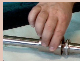
21. Analogicznie dostosowujemy średnicę teflonu na tłok.
