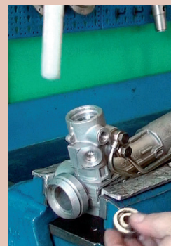
11. Wyciągamy łożysko rozdzielacza przy pomocy wybijaka teflonowego i uderzając tylko w zewnętrzny pierścień.
