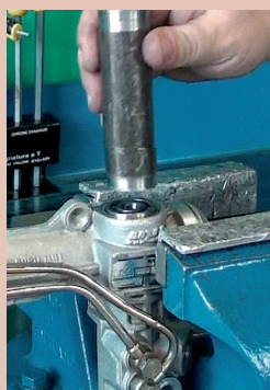
23. Wciskamy łożysko, stukając tylko w zewnętrzną pierścień.
