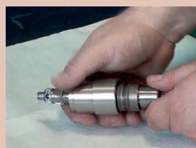
19. Dostosowujemy zewnętrzną średnicę teflonów do oryginalnego rozmiaru, używając specjalnych tulei z grupy Z-09050/Z-09064.
