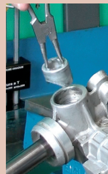
5. Ściągamy sprężynkę i docisk, upewniając się, że jest nieodkształcony.
