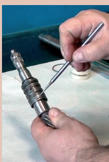
15. Ogranicznik rozdzielacza i jego mocowanie muszą być w idealnym stanie, żadne luzy nie są dopuszczalne.
