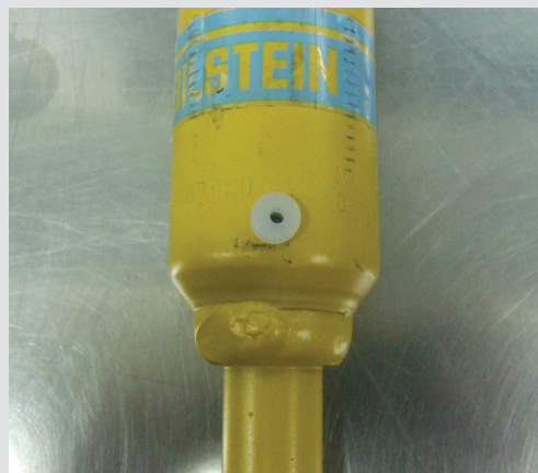
Εικ. 41: Το καπάκι είναι μέσα στην οπή των 4mm.
