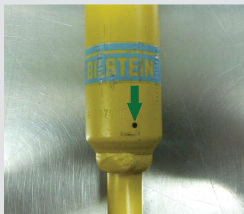
Εικ. 38: οπή 2mm για εκτόνωση του αζώτου. Ακολουθώντας γίνεται 4mm.
