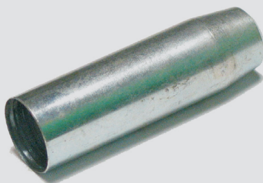
Εικ. 36: Ο εγχυτήρας 93-654 χρησιμοποιείται για την κάλυψη του πείρου της ράβδου και την προστασία της τσιμούχας κατά την τοποθέτηση.
