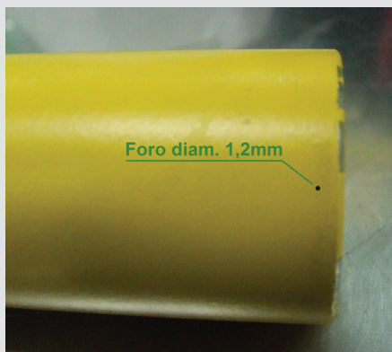
Εικ. 34: οπή 1,2 mm για την απομάκρυνση του εξωτερικού δακτυλιδίου ασφάλισης.
