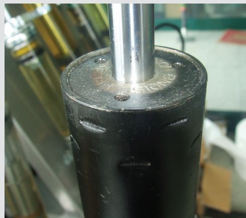
Εικ. 43: Αμορτισέρ μονού σωλήνα Boge-Sachs με τον οδηγό και το σώμα πιεσμένα μαζί.
